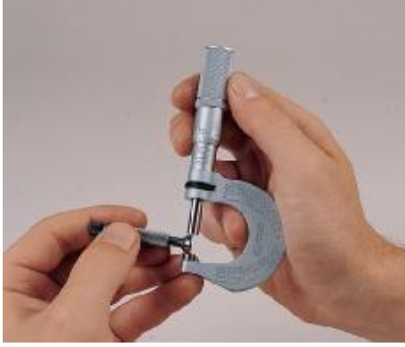
Hình 3.13. Sử dụng Panme đo ngoài để đo đường kính chi tiết
