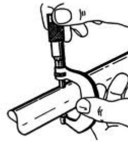
Hình 3.13. Sử dụng Panme đo ngoài để đo đường kính chi tiết
